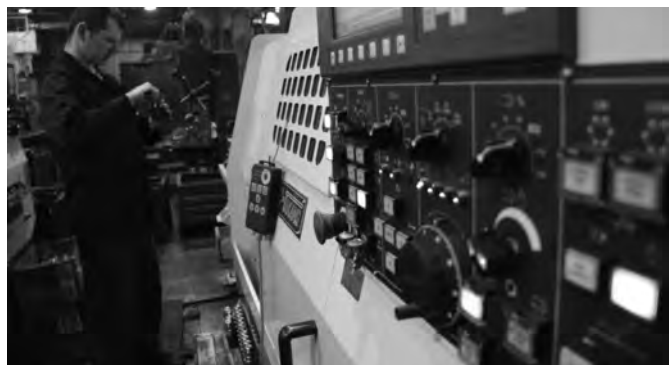
• токарный полуавтомат с ЧПУ для изготовления шпинделей и гаек шпинделей
